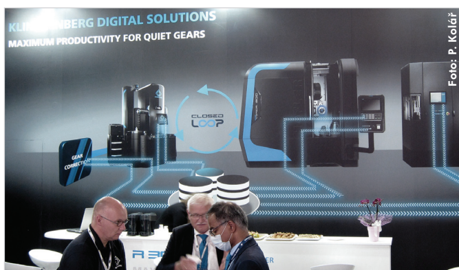
Příklad ucelené datové komunikace mezi více výrobními stroji firmy Klingenberg. Hlavním strojem výrobního systému je bruska na ozubení, která je doplněna přípravou nástrojů a postprocesní kontrolou jakosti výrobků.
